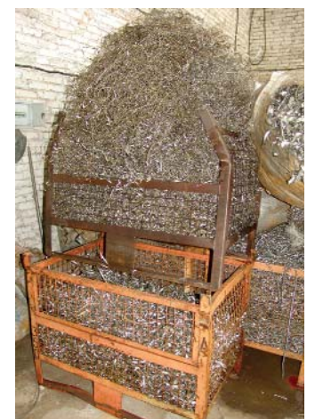
Утилизация «черной» стружки — головная боль для многих металлообрабатывающих предприятий. Здесь она сортируется и отправляется на переплавку
