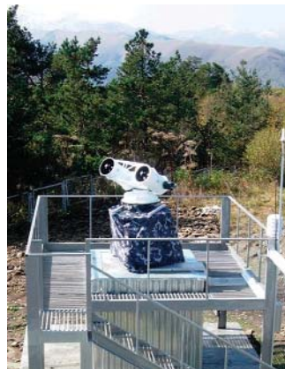
Малогабаритная модульная квантово-оптическая система «Сажень-ТМ». Вариант исполнения лазерный локатор. (Северный Кавказ)
