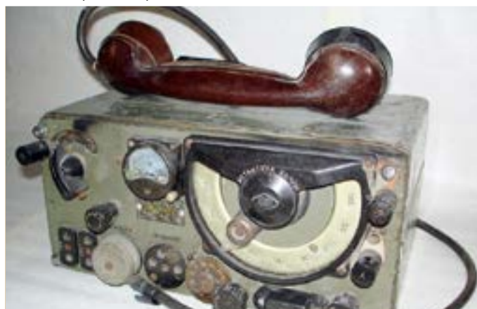
Радиостанция А-7 — первая массовая советская радиостанция с частотной модуляцией. Модели А-7-А и А-7-Б начали поставляться в войска в 1944 году
