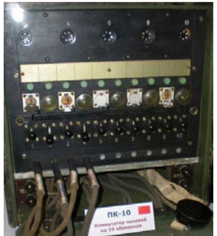
Полевой коммутатор ПК-10 на десять абонентов в кожухе защитного исполнения обычно использовался на КП стрелкового или артиллерийского полка
