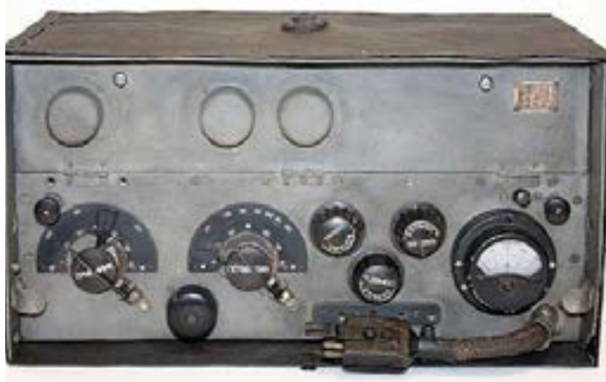
Танковый передатчик 71-ТК-1 (обр. 1933 г.) был изготовлен в Москве на заводе № 203 в 1938 году. Устанавливался на быстроходные легкие танки БТ-5, БТ-7, Т-28, а также Т-34 первых выпусков
