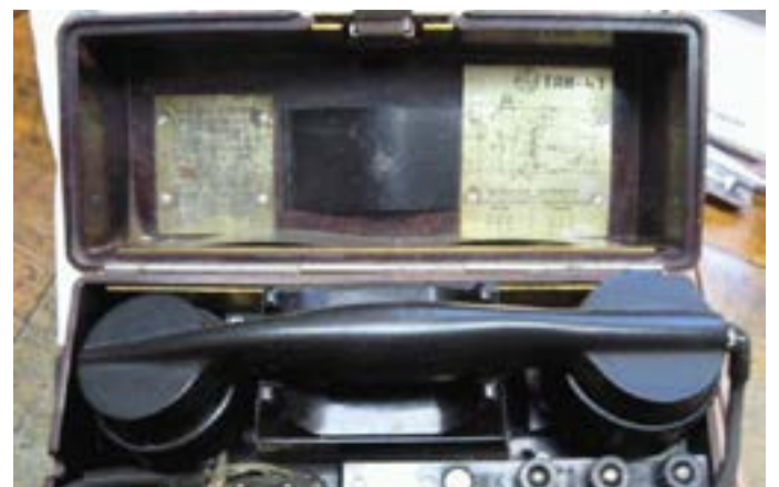
Военно-полевой телефонный аппарат системы МБ с индукторным вызовом. Поступил на вооружение в 1943-м. Пришел на смену семейству УНА. Долгое время оставался основным средством связи Советской армии
